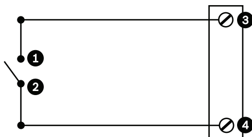
Figure 9.2 N.O. - Normalement ouvert
